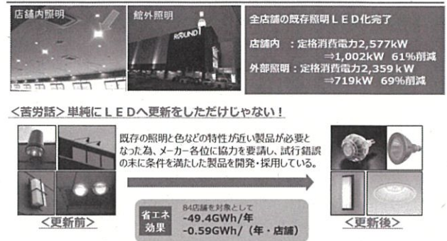
図-5 効率的なLED照明への更新
